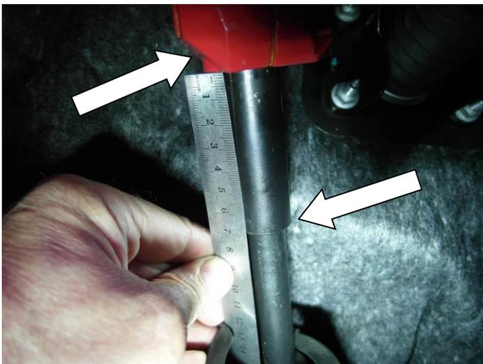
Муфта крепится в средней части верхнего промежуточного рулевого вала, на расстоянии 70 мм от соединения с нижним валом.
